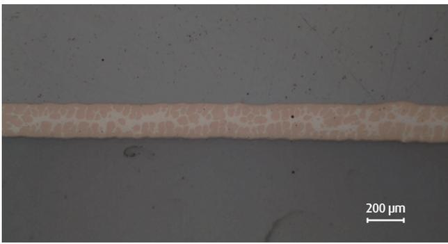
Abbildung 26 | Lötung von BrazeTec 49/Cu bei 1.100 °C und 180 Sekunden
