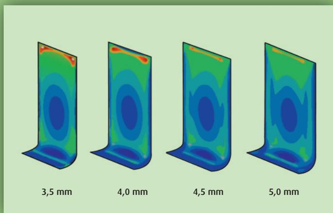
**Abbildung 19** | Zugspannungen im Hartmetallzahn bei Verwendung verschiedener Lotbandbreiten [25]
