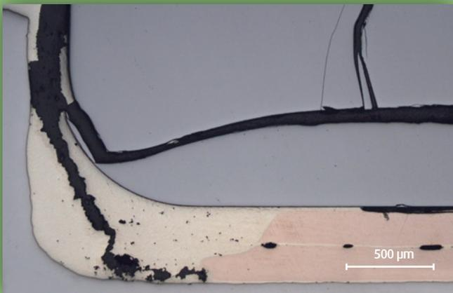
Abbildung 31 | Fehlerhaft ausgeformtes Sägenstammbblatt
