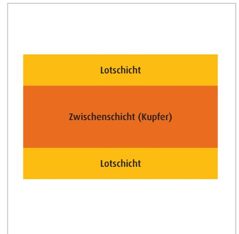
Abbildung 13 | Schematischer Querschnitt durch ein Schichtlot
