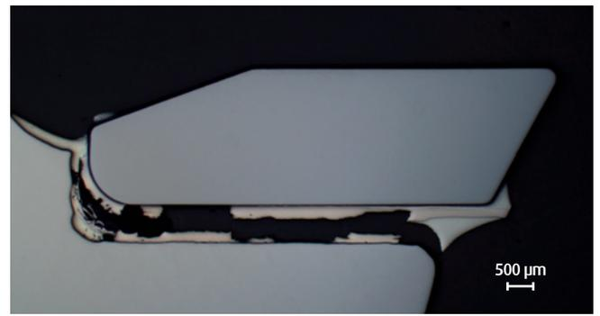
Abbildung 27 | Hartmetall-Sägezahn gelötet mit BrazeTec 49/Cu. Bruch der Fügeverbindung in der Kupferzwischen-schicht [37]
