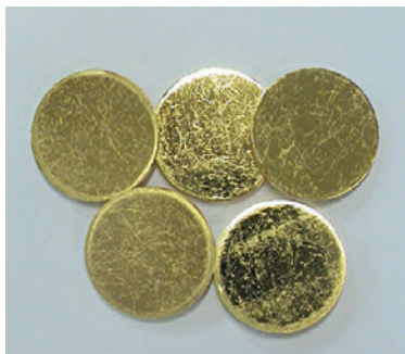
Au 5N \varnothing 20 x 1.5 mm discs
